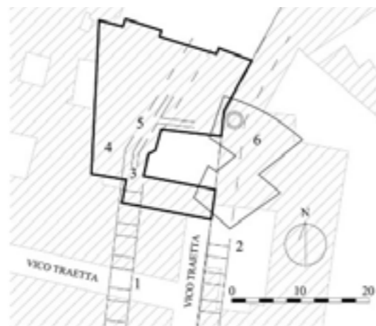
Fig. 5 – Palazzo de' Mari: 1) ponte-canale dell'acquedotto augusteo; 2) ponte canale est; 3) sezione dello speco augusteo; 4) piegatura della parete ovest del canale augusteo; 5) intersezione dello speco augusteo con quello trasversale; 6) cisterna con pilastro pozzo. La linea in grassetto indica i confini del palazzo, l'altra quelli della cisterna.
